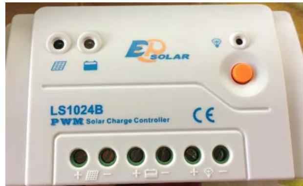
Figura 4. Controlador de carga
