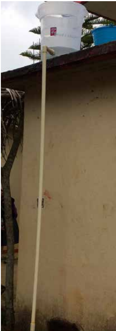
Figura 8. Caída del agua hacia el generador hidráulico.
