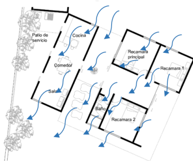
Figura 8. Corrientes de aire en la vivienda para la familia. NOTA: elaboración propia
