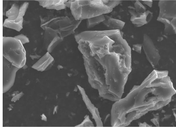
FIGURA 1. Carbón sin activar de bagazo de Agave angustifolia Haw, magnificación a x950 obtenida mediante SEM JSM-IT300LV.
