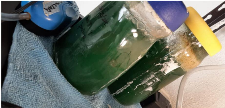
**Figura 1.** Fotobiorreactor cerrado. Elaboración propia. Son fotobiorreactores en donde se cultiva la microalga *Espirulina* en los laboratorios de la Escuela Superior de Apan
