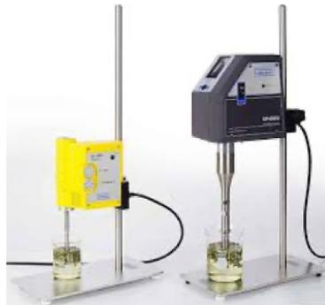
**Figura 4.** Homogeneizadores ultrasónicos UPI00H y UP400St: Sonicación para lisis y extracción celular. Tomada de Feng, Hao & Barbosa-Canovas, Gustavo & Weiss, Jochen. (2011)
