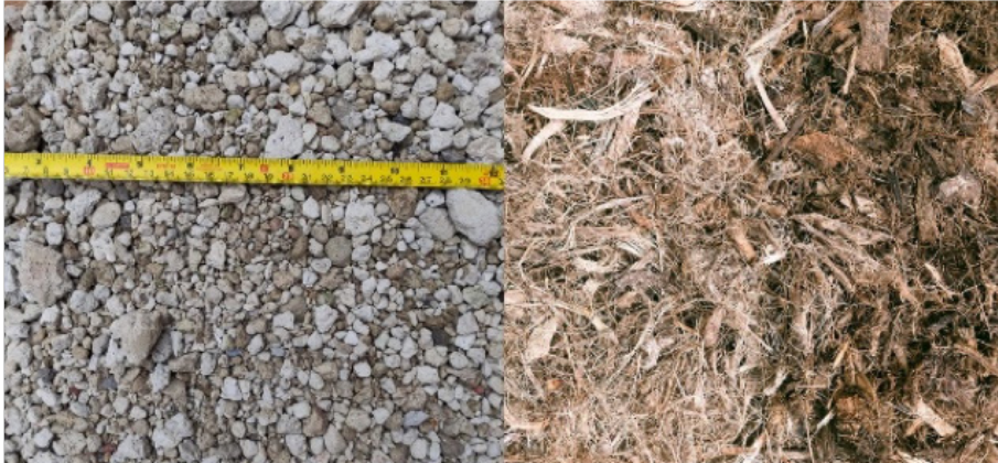
Figura 3. Materiales estabilizantes. Izquierda: polvo de piedra volcánica (PPV). Derecha: bagazo de maguey (FBM). Fuente: Elaboración propia
