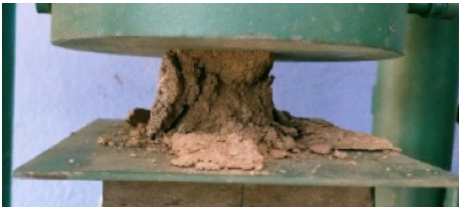
Figura 5. Prueba de compresión axial en cubos de 100 x 100 x 100 mm. Fuente: Elaboración propia
