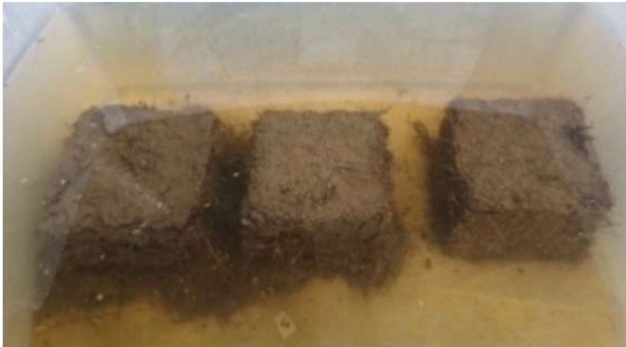
Figura 6. Sumersión de cubos de las mezclas durante siete días. Fuente: Elaboración propia
