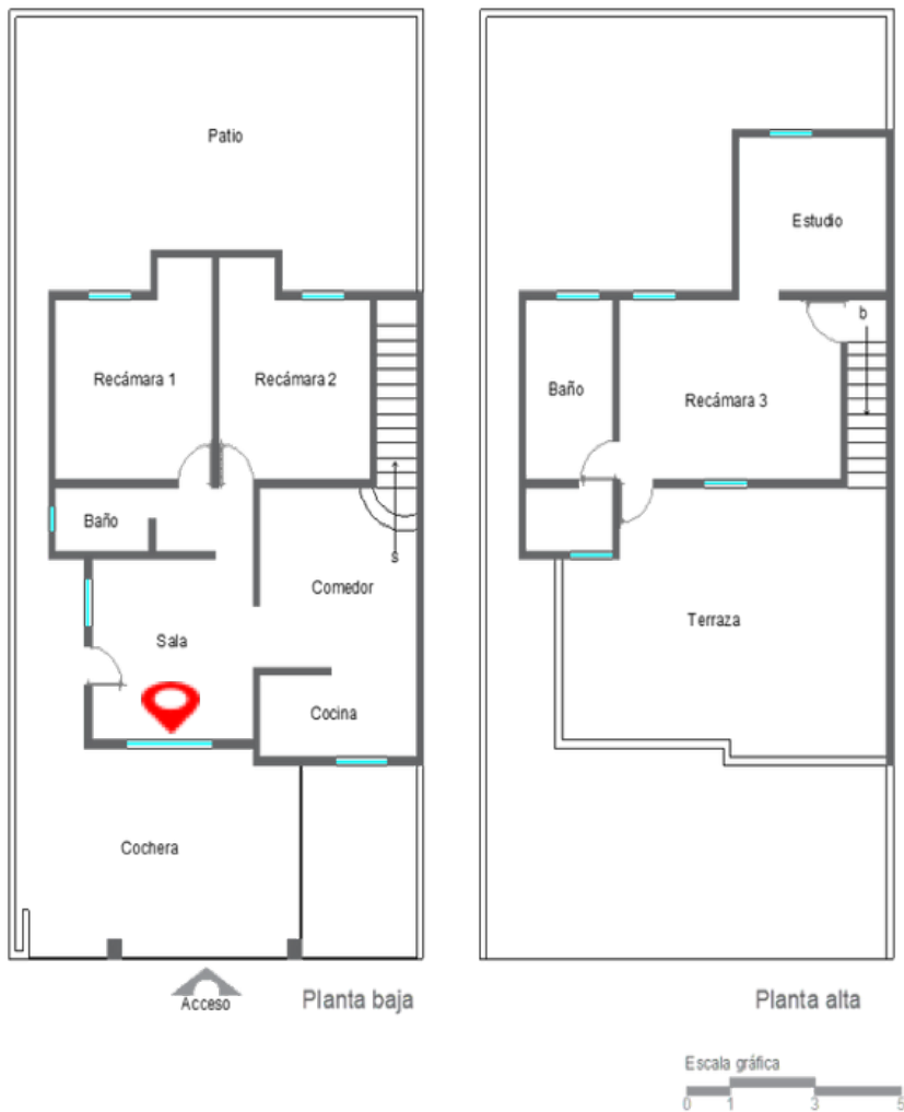
Figura 2. Distribución arquitectónica y ubicación del sistema de medición de bajo costo. Elaboración propia.
