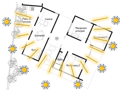
Figura 10. Dirección del sol en la vivienda diseñada para la familia. NOTA: elaboración propia.
