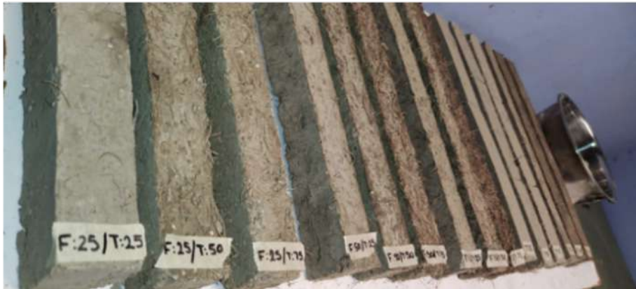
Figura 4. Especímenes para cálculo de contracción por desecación. Fuente: Elaboración propia
