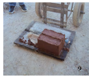
Figura 7. Mezclado manual de las mezclas. Figura 8. Moldeado en bloquera local. Figura 9. Piezas moldeadas del bloque a base de residuos industriales oaxaqueños. Fuente: Acervo fotográfico propio de KPLF.
