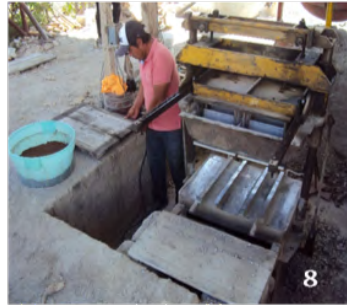
Figura 7. Mezclado manual de las mezclas. Figura 8. Moldeado en bloquera local. Figura 9. Piezas moldeadas del bloque a base de residuos industriales oaxaqueños. Fuente: Acervo fotográfico propio de KPLF.
