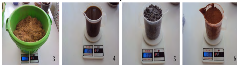
Figura 3. Pesado del bagazo molido. Figura 4. Pesado de la vinaza. Figura 5. Pesado del lodo de papel. Figura 6. Pesado del polvo de ladrillo.
